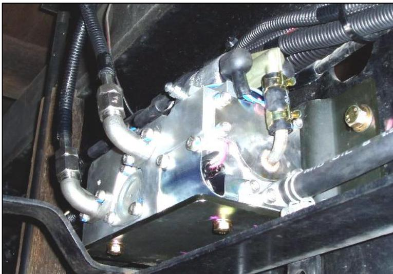
燃料供給装置の搭載例
