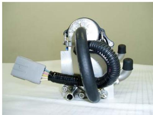
燃料供給装置(側面)
